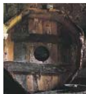
Guardapolvos o cubierta de madera que protege las muelas y evita tanto que se genere polvo y salga la harina, como que se cuelean elementos extraños. A la izquierda podemos observarlo retirado y a la derecha en su posición correcta sobre el único par de muelas que se conserva.
